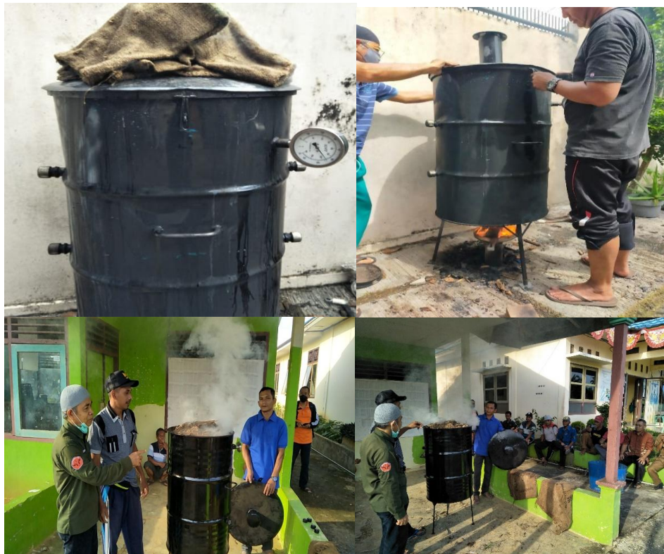
Gambar 3. Proses bimbingan dan uji coba pembuatan biochar dari batang kelapa sawit dengan alat pirolisis yang dirancang dan dibuat oleh Tim pengabdian.
